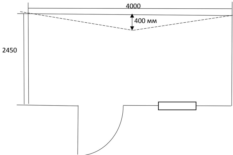
Спецификация на бытовку р-р 4000x2450 с крышей в разрез, арт. 194
